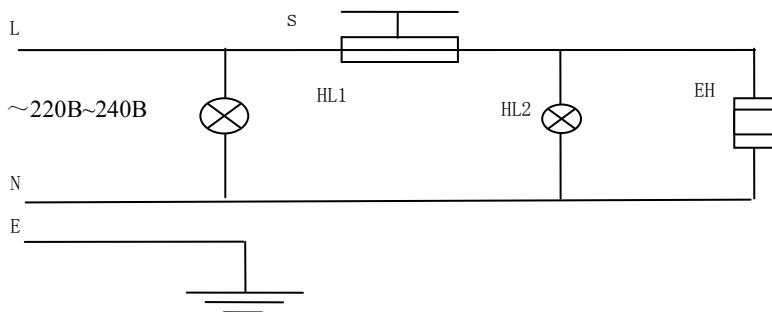
S—РЕГУЛЯТОР ТЕМПЕРАТУРЫ      EH—НАГРЕВАТЕЛЬНАЯ ТРУБКА
