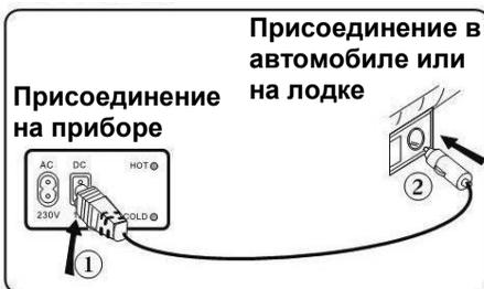
Один конец **кабеля DC** подключить к присоединению DC прибора ①, а второй конец ② к гнезду прикуривателя, напр., в автомобиле или на лодке.
