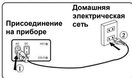
Один конец **кабеля АС** подсоединить к присоединению АС прибора ①, а второй конец ② к гнезду домашней электрической сети.
