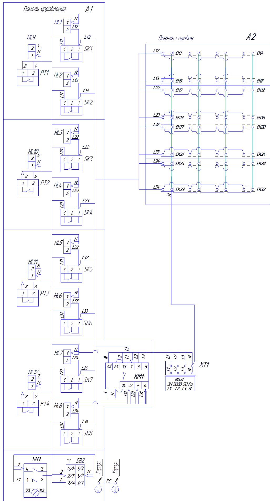
Рисунок 4 – Схема электрическая соединений печи.
