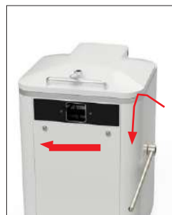
6. Перевести прижимную рукоятку вперед вплоть до полного отрезания теста
