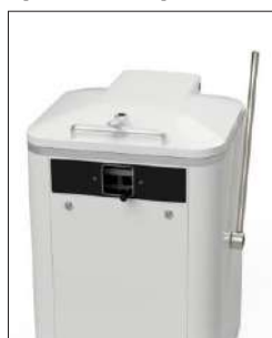
2. Отвести прижимную рукоятку назад до упора, опуская таким образом прижимные рамы и нож
