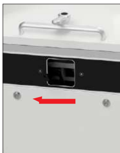
5. Слегка отпустить прижимную рукоятку и перевести рукоятку отрезания влево, освобождая таким образом нож
