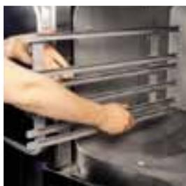
Направляющие ГН легко снимаются и их можно мыть в посудомоечной машине. Закругленная, бесшовная конструкция облегчает очистку. В камере сливная труба.
