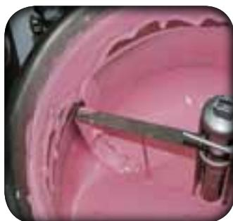
**Автоматическое охлаждение ледяной водой (C3).** Охлажденная вода циркулирует между льдогенератором и рубашкой котла (замкнутый цикл).
