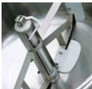
Один перемешивающий механизм со съемными скребками для всех видов смешивания. Легкая, но прочная уникальная конструкция.
