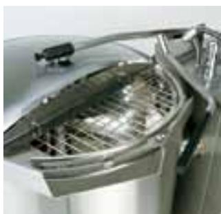
Съемная решетка обеспечивает непрерывное наблюдение за приготовляемой пищей и добавление ингредиентов, воды и специй при работающем миксере.
