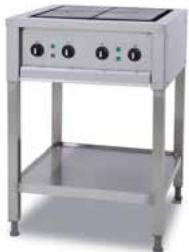
Модель Minor 4 – представляет собой плиту RP4 в миниатюре. Габариты плиты 600 x 600 x 900 мм прекрасно вписываются в небольшую кухню с глубиной рабочего места 600 мм. Плита содержит четыре чугунные конфорки с шарнирным креплением размером 220 x 220 мм и мощностью 2 kW. Каждая конфорка оборудована 4-ступенчатым регулятором мощности и сигнальным индикатором. Под конфорками имеется съемный поддон из н/стали для облегчения чистки. Открытая подставка с полкой.
