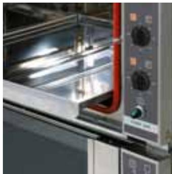
В жарочном шкафу съемная емкость для сбора грязи, которая служит также емкостью увлажняющей воды. В емкость устанавливается также каменный под (поставляется за доплату).
