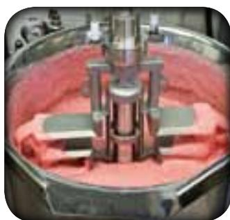
**Автоматическое охлаждение котлов Proveno Chill Pro ледяной водой (ожидается в 2013 г. для новых Proveno)**
