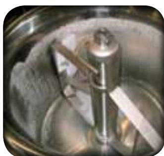
**Ручное охлаждение (C1)** водопроводной водой: пользователь вручную подсоединяет водяной шланг к водопроводу и регулирует водопроводные краны, впускной и выпускной клапаны рубашки котла до и после цикла охлаждения.
