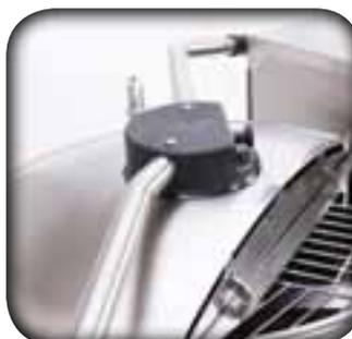
Съемная защитная решетка обеспечивает непрерывный контроль за приготовлением и добавлением ингредиентов в процессе смешивания
